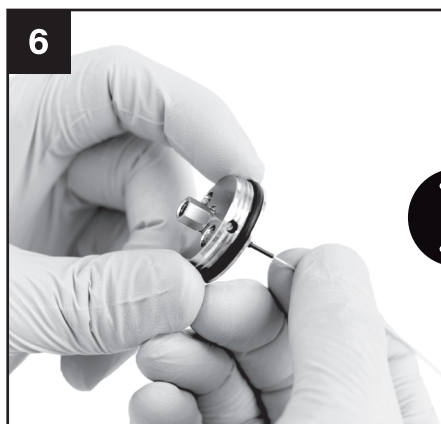
Auroraカラムをメタルハウジングに通し、CSIプローブを組み立てます (ネジ2式)。この時、ラバーシールがメタルハウジングとAurora CSI フィッティングの間に取り付けられていることを確認してください。
