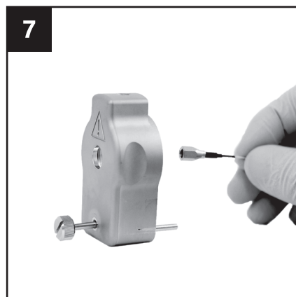
CSIプローブハウジングにAuroraカラムのnanoZero®フィッティングを通します。
