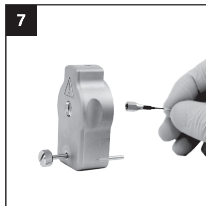
将带有nanoZero®装配件的Aurora色谱柱穿过CSI探头壳体。
